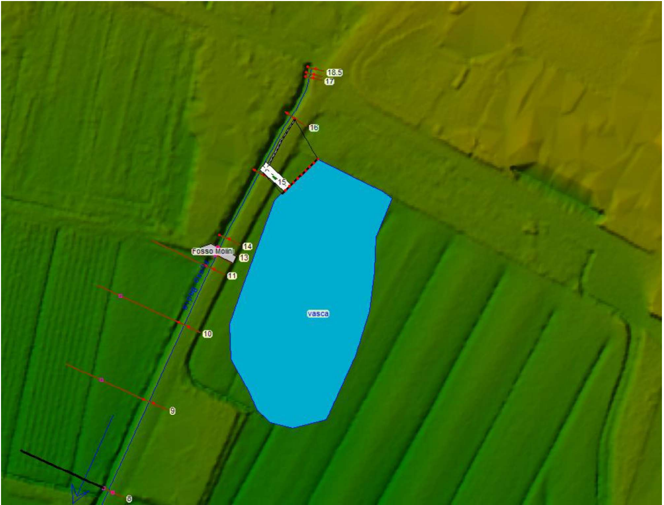
Figura 17 – Simulazione idraulica vasca di laminazione in previsione
