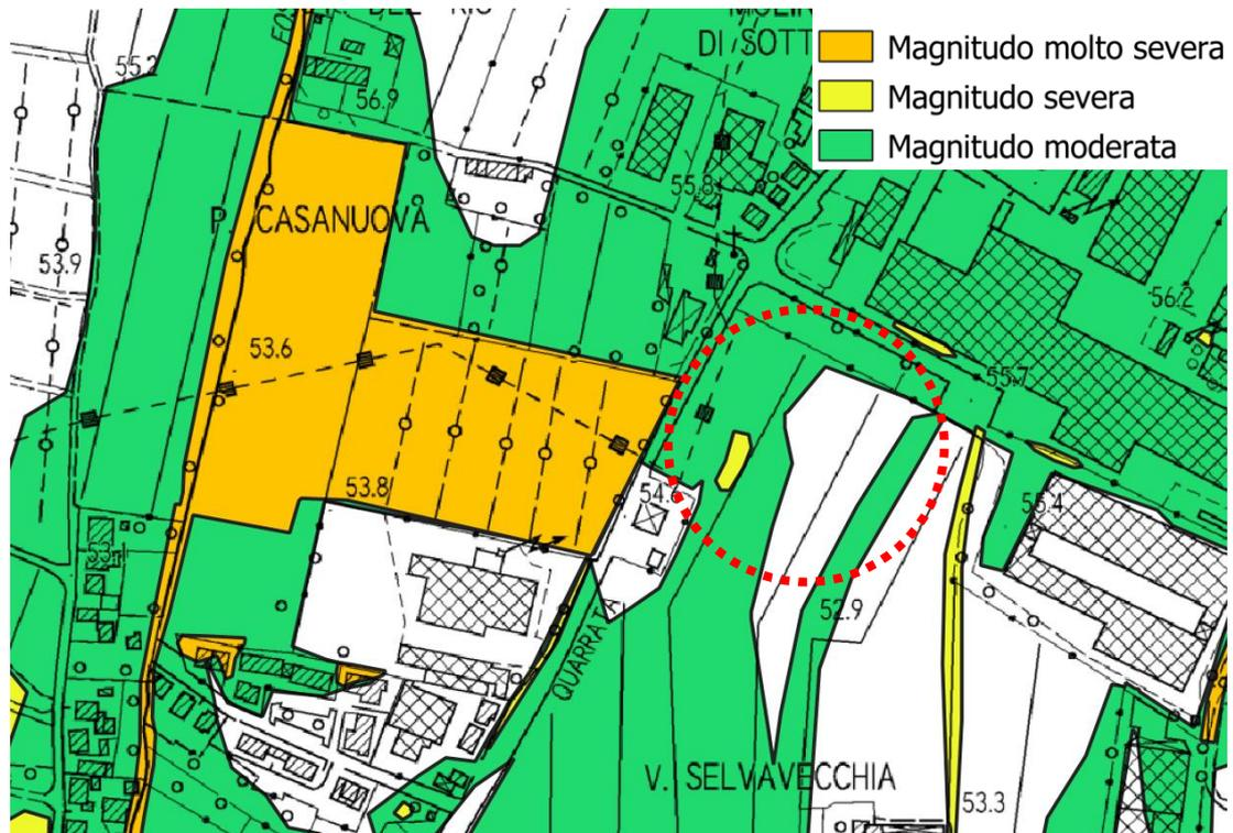
Figura 9 – Estratto tavola I.05 del nuovo PS, magnitudo idraulica (da modellazione)
