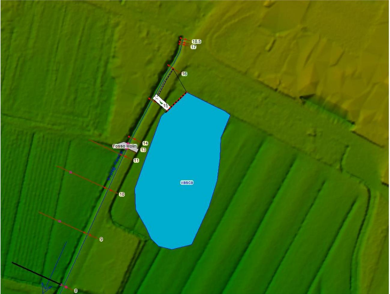
Figura 17 – Simulazione idraulica vasca di laminazione in previsione
