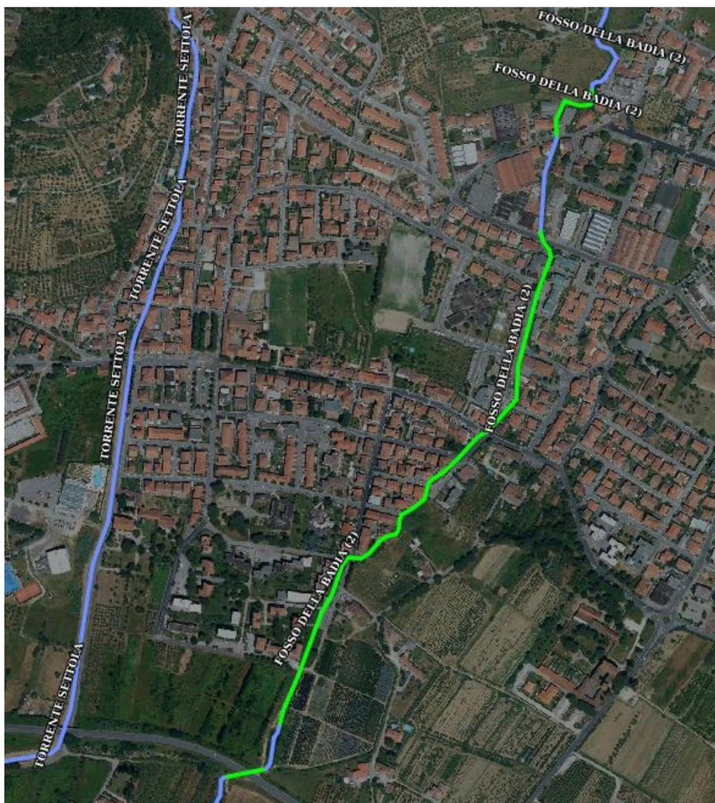
Figura 10 – Tratti tombati del Fosso della Badia nella parte di monte, che giustificano l'utilizzo di un modello SWMM per la determinazione delle esondazioni
