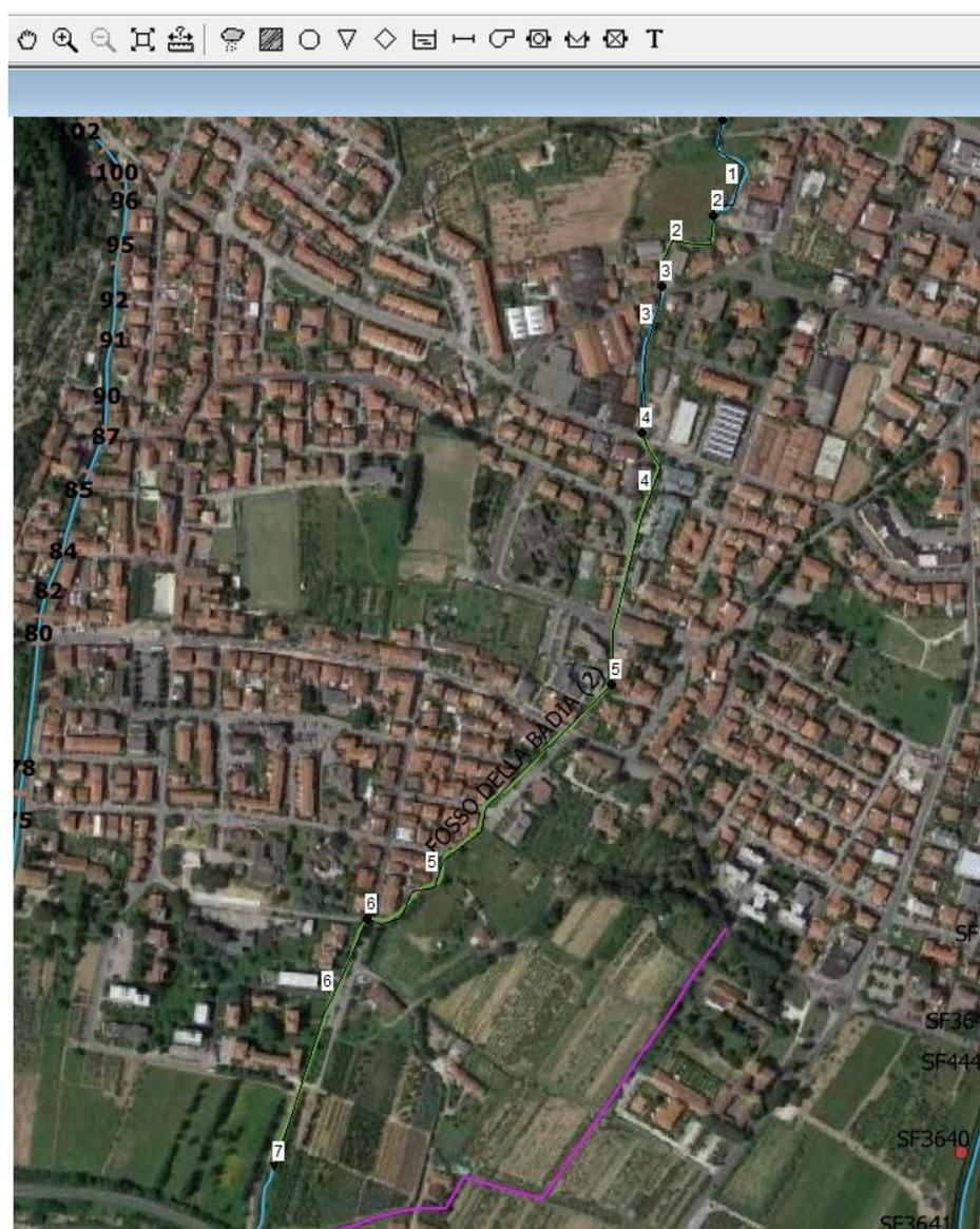
Figura 11 – Modello SWMM implementato per il tratto di monte urbanizzato del Fosso della Badia
