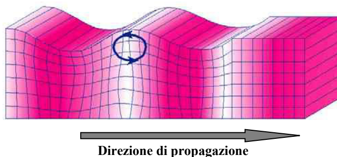
Fig. 1 - Rappresentazione grafica della propagazione delle onde superficiali di Rayleigh caratterizzata dall'oscillazione polarizzata in un piano verticale e con movimento delle particelle retrogrado rispetto al senso di propagazione dell'onda.
