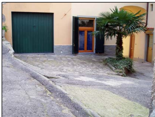
foto 3: slargo sulla via Atto Vannucci, a Tobbiana. Si nota un'evidente disomogeneità dei livelli di calpestio e della pavimentazione. In particolare la sagomatura dei bordi stradali, finalizzata al convogliamento delle acque meteoriche, rappresenta un forte ostacolo alla mobilità.
