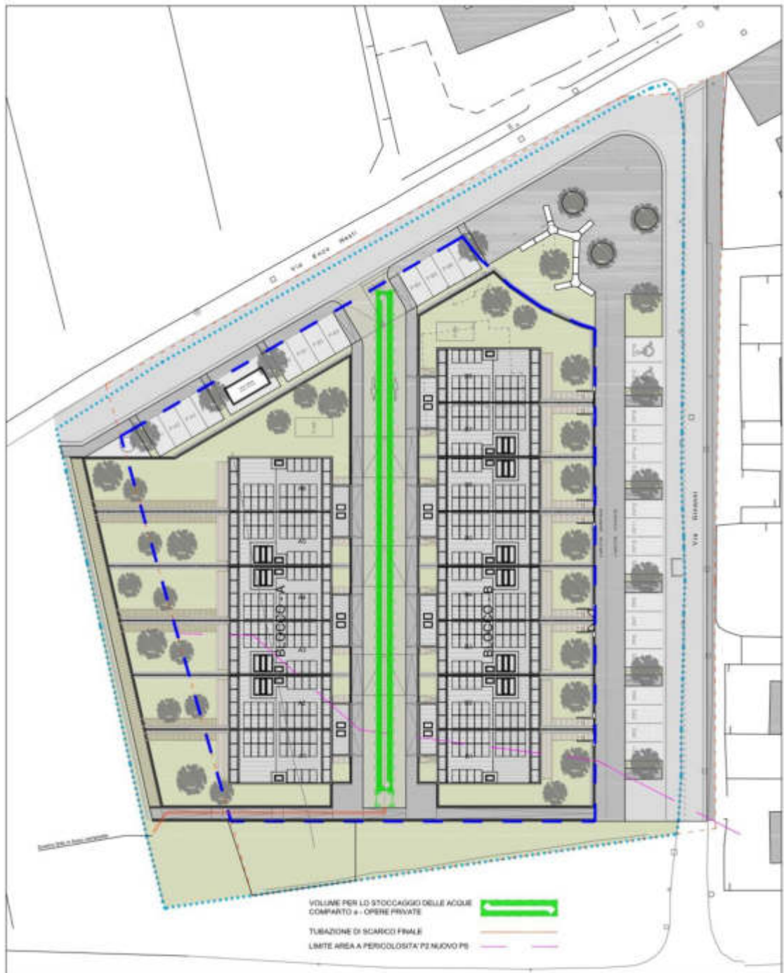
Fig. 10 – Schema del sistema di stoccaggio delle acque piovane con recapito finale in fosso campestre
