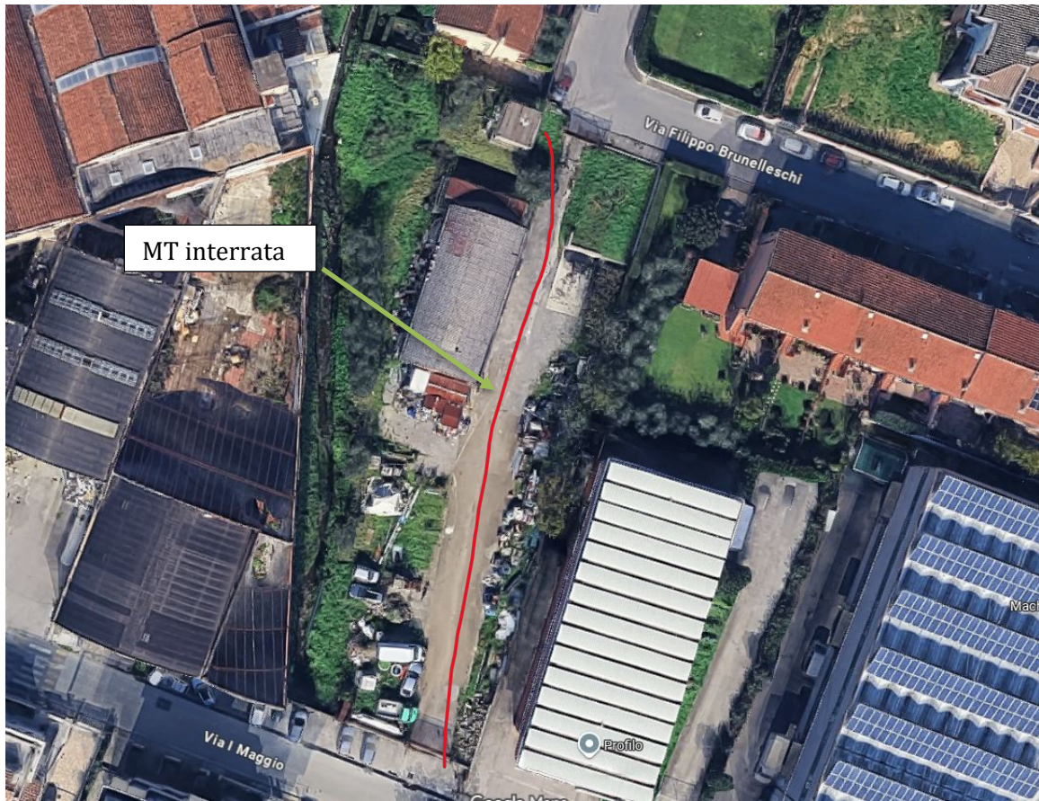
Mappatura del sottoservizio MT
